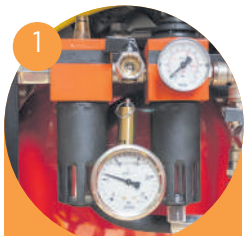
Treatment of area/ Tratamiento d'aire
